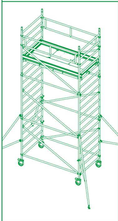
Una volta completato il montaggio della torre dovranno essere posizionati i piani di lavoro secondo le indicazioni riportate, alle altezze desiderate, comprensivi delle tavole fermapiede oltre che delle protezioni laterali;
